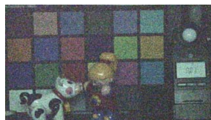
被写体照度 0.01lx 環境下での撮影映像 キャプチャサンプル
